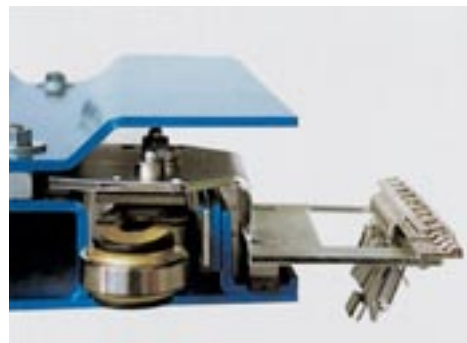
Horizontale Nadelkette mit Abnadelschutz und Kugellager-Zugkette
